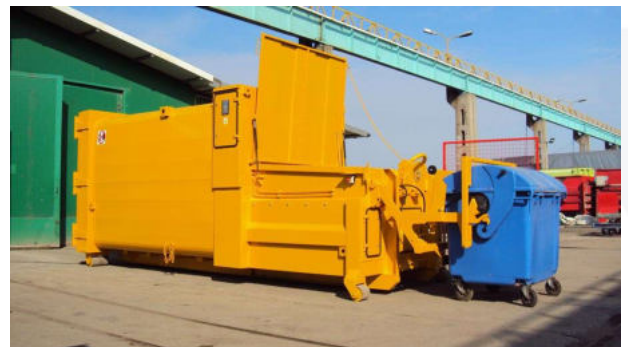
Perscontainer met kantelsysteem
