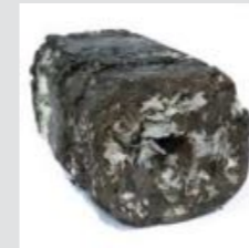
Gecompacteerd blok, EPS asfalt/teer verkleving
