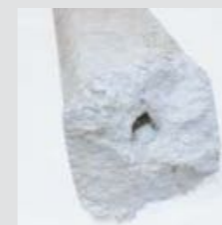
Gecompacteerd blok van EPS
